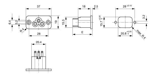
E: Lötanschlüsse kurz: 19.9 mm E: Lötanschlüsse lang: 25.9 mm E: Steckanschlüsse 2.8x0.8 mm: 23.6 mm PCB
