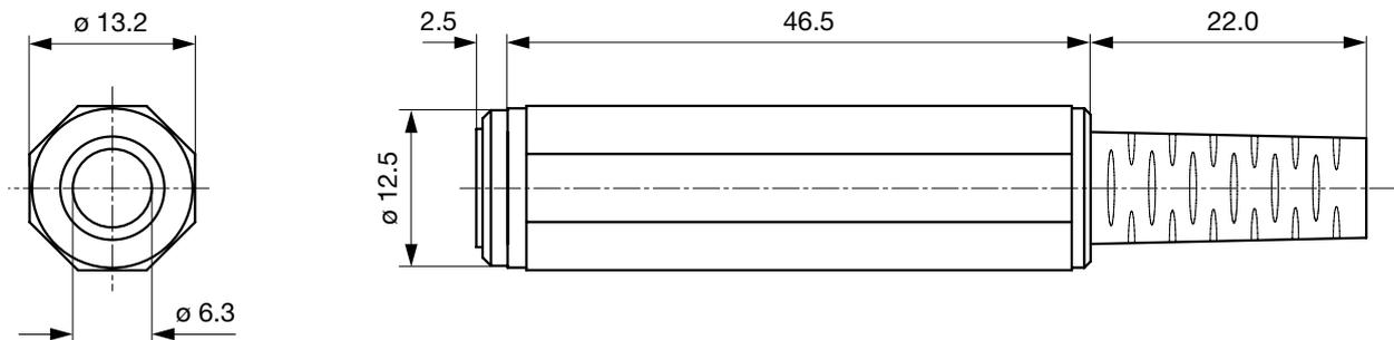
Kabeldurchmesser max. 6.3 mm
